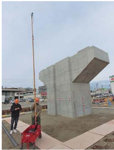
法政大学デザイン工学部都市環境デザイン工学科の今井龍一教授が主宰する社会空間情報研究室と、トップライズ(新潟市、大滝充司社長)は、自己位置の推定と、周囲環境の把握(環境地図作成)を同時に行つSLAM技術を活用し、出来形計測時に死角となる橋脚天端部の3次元データを簡易かつ効率的に取得するシステムを構築した。廉価なLiDAR(レーザー式測距装置)を中心とした既製品で構成されており、補備測量の分野ではコスト、作業性の観点から高い将来性が見込まれる。加賀田組が施工する国土交通省直轄工事で実証実験を進めており、工事現場への適用は全国初となる。
